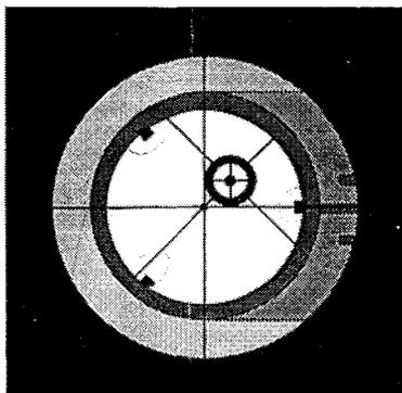
Figure 3. Le miroir secondaire est correctement aligné (incliné).
