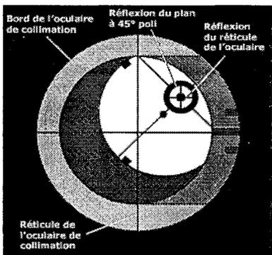
Figure 2. Vue à travers l'oculaire de collimation (comme les deux figures suivantes). Le miroir secondaire est centré par rapport au tube de l'oculaire de collimation.
