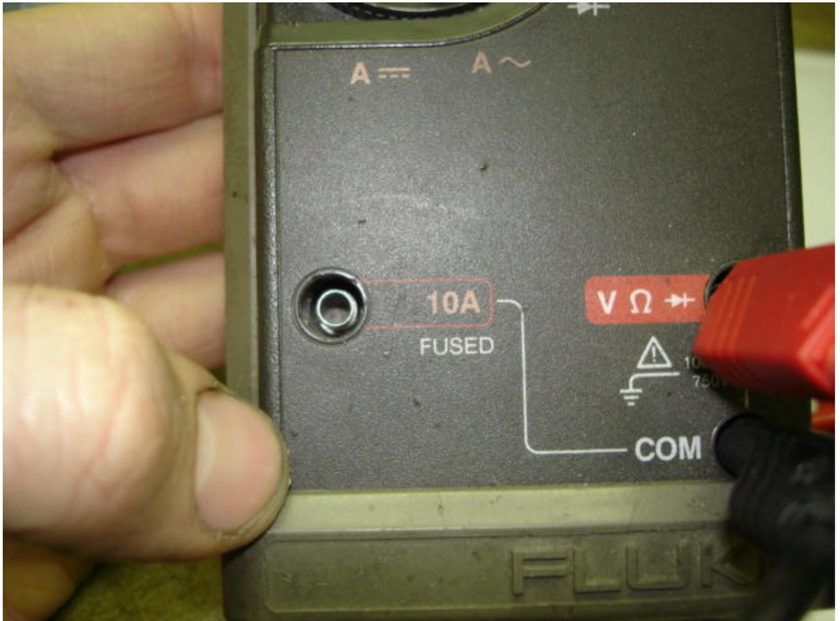
**On remarque que le fil noir ne bouge pas de son emplacement marqué COM pour commun et le rouge peut se mettre soit à droite pour la mesure de tension, de résistance et de diode , alors que l'emplacement de gauche permet de mesurer des courants, jusqu'à 10 ampères dans notre cas.**
