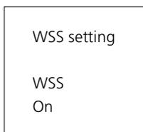
Certains émetteurs TV envoient une information facilitant l'identification du format d'image, permettant ainsi au téléviseur de commuter automatiquement sur le format idoine quand la fonction WSS est en service. L'option "WSS On" porte sur l'ensemble des sources d'image, qu'il s'agisse du sélecteur de canaux TV, satellite ou vidéo, ou de la lecture vidéo.
