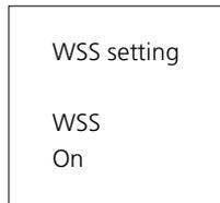
Algunas emisoras de TV transmiten una identificación del formato de imagen, permitiendo al televisor cambiar automáticamente al formato correspondiente si WSS está activado (On). Con WSS activado, la detección afectará a todas las fuentes de imagen, es decir, sintonizador de TV, sintonizador de satélites, sintonizador de vídeo y reproductor de vídeo.
