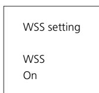
Alcune emittenti televisive trasmettono un segnale di identificazione del formato immagine, permettendo al televisore di impostare automaticamente il formato corretto quando WSS è attivo. Con WSS attivo, il rilevamento viene eseguito su tutte le sorgenti dell'immagine, cioè il sintonizzatore TV, il sintonizzatore satellite, il sintonizzatore video e la riproduzione video.
