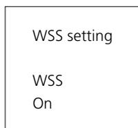
Gewisse Fernsehsender strahlen ein Bildformat-Identifikationssignal aus, so daß das TV-Gerät automatisch zum korrekten Format umschaltet, wenn WSS in Stellung 'On' steht. Bei 'WSS On' werden alle Bildquellen abgetastet, d.h. TV-Tuner, Satelliten-Tuner, Video-Tuner und Video-Wiedergabe.
