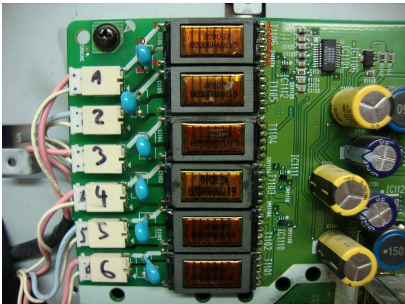
Le remplacement d'un des transformateur a résolu mon problème et le téléviseur remarche correctement.
