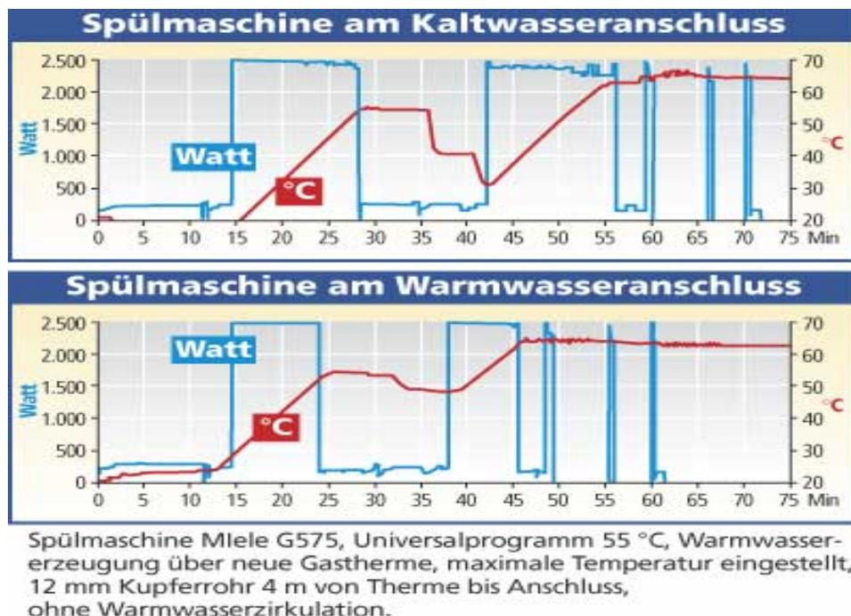
Mesures de consommation réelles d'une machine connectée à l'eau froide (en haut), et à l'eau chaude 55 deg.C (en bas), en tenant compte de 4 m de conduites de 12 mm (sans recirculation). Au début des cycles, l'eau contenue dans la conduite est froide ou tiède. Il s'agit ici aussi de minimiser le volume de la conduite, donc sa longueur et son diamètre, et de bien isoler...
