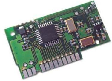
Ce module permet de réaliser une **liaison numérique bidirectionnelle jusqu'à 1000m**.
