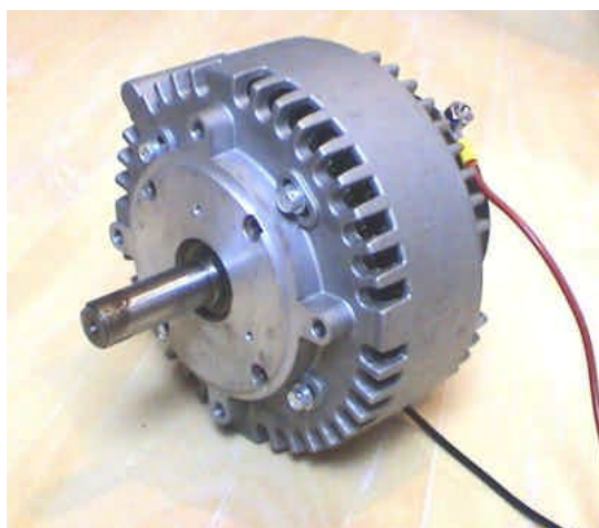
Figure 2.9. Le moteur électrique E-tek et son schéma équivalent (images-maquettes\12VDC51V-12.jpg & dessins\rl1.drw).
