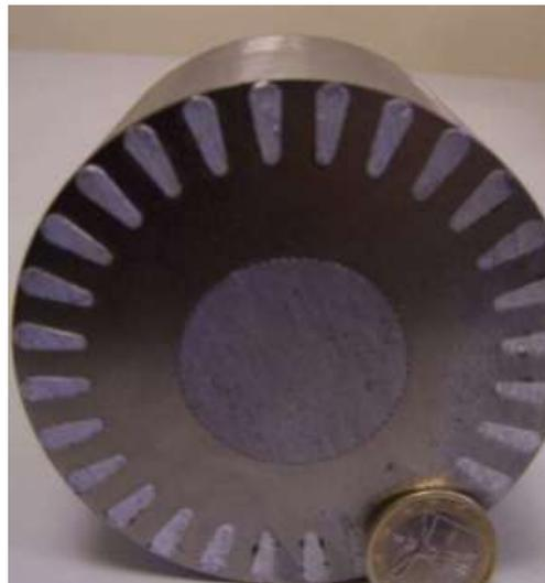
FIGURE 5.7 – Coupe d’un rotor à cage (Source : [http://fr.academic.ru/pictures/frwiki/67/Coupe\\_rotor\\_machine\\_asynchrone.jpg](http://fr.academic.ru/pictures/frwiki/67/Coupe_rotor_machine_asynchrone.jpg))
