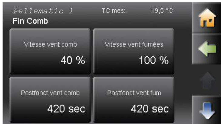
Le menu **fin combustion** comprend les fonctions nécessaires à la mise à l'arrêt de la chaudière:
