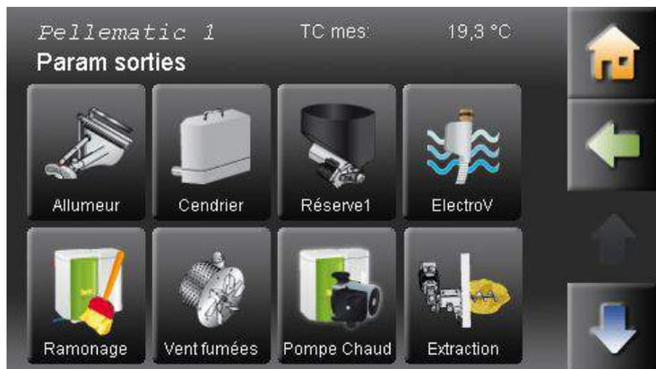
Il comprend les paramètres de contrôle des sorties de l'automate de chaudières:
