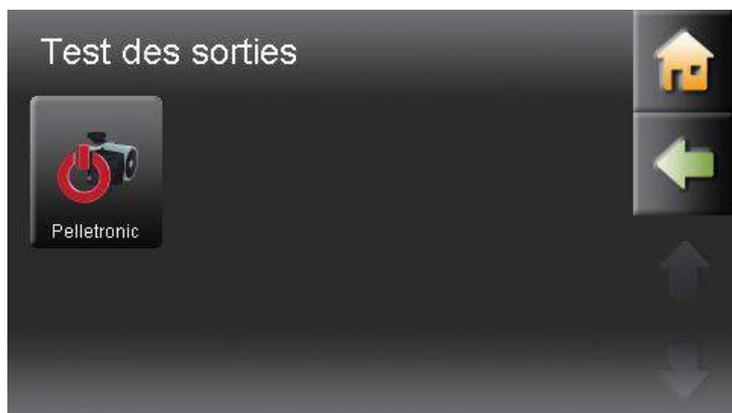
Cette fonction vous permet de tester individuellement le fonctionnement de chacune des sorties de la régulation et de l'automate de la chaudière.
