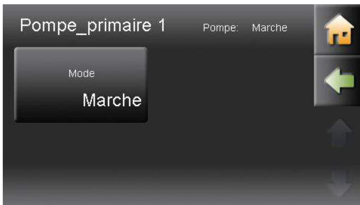
Une pompe primaire est une pompe de soutien, pompe utile si l'installation comporte des réseaux hydrauliques distants de la chaudière ou du ballon tampon. Cette pompe fonctionne en même temps que les pompes de tous les circuits qui sont ici déclarés. Chaque boîtier de câblage ne peut piloter qu'une unique pompe primaire. Activez ou désactivez avec le mode **Marche** ou **Arrêt** cette pompe primaire.
