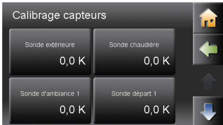
En cas de longueur importante de câble de sonde, la mesure des capteurs peut dévier légèrement de la réalité. La fonction calibrage vous permettra alors de corriger la mesure de +/- 20°C.
