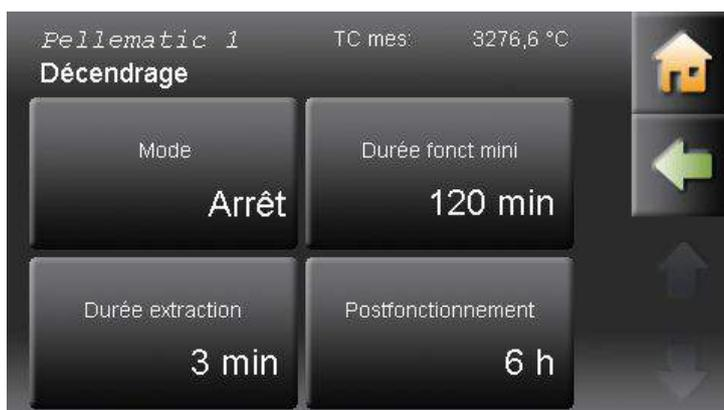
Ce menu n'apparaît que si un cendrier extérieur ou une assiette à décendrage a été commandé puis paramétré dans le menu protégé lors de la mise en route de la machine. Le cendrier extérieur et le décendrage de l'assiette fonctionnent en même temps.
