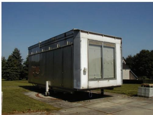
Le fonctionnement de la cellule est similaire à celui d'un calorimètre, avec la possibilité d'obtenir une mesure précise des échanges de chaleur (gains et pertes) à travers le composant testé. La chambre d'essai est équipée d'un système de chauffage et de refroidissement (voir figure 10) permettant d'adapter la température de l'air dans la cellule à la valeur de consigne souhaitée.
