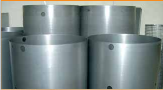
Bild 1: Rohmaterial als Zylinderform aus Stahl ST37-2 gerundet und geheftet
