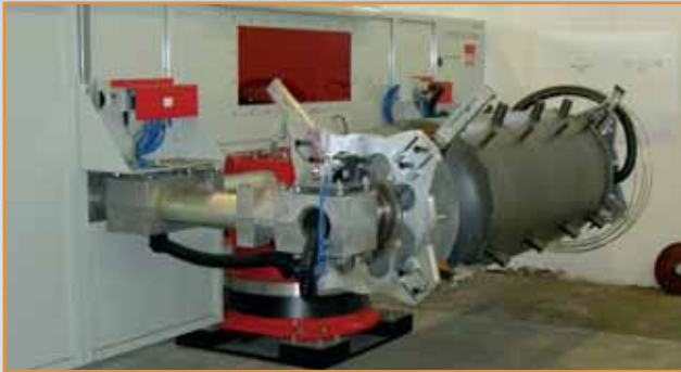
Bild 3: In diesem Bereich wird der Behälter in die Spannvorrichtung eingelegt und zentriert.
