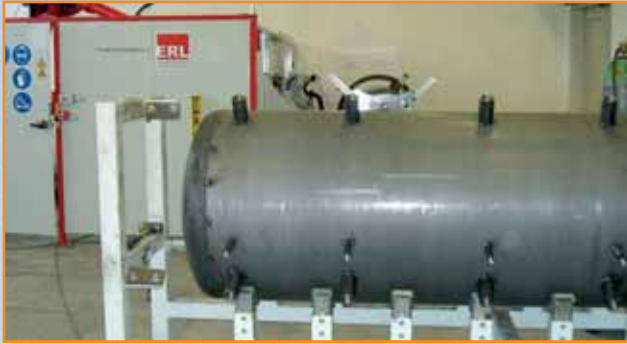
Bild 2: Hier werden die Zylinder mit Muffen, Deckel, Fußring und sonstigem Innenleben bestückt und angeheftet
