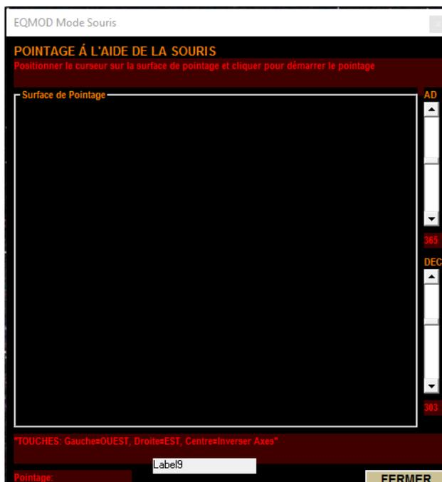
Cela permet de faire bouger la monture uniquement avec la souris que l'on tient dans sa main, sans la poser, et donc cela permet d'aller à côté de sa monture, regarder dans un oculaire ou le viseur polaire tout en faisant bouger la monture à volonté. Mode extrêmement utile pendant les mises en station ou observation.
