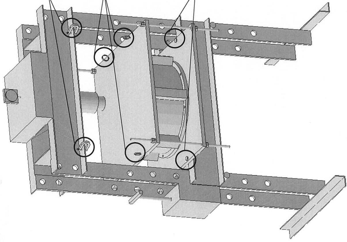
**PS :** Une fois les chaînes tendues, la distance entre le piston de la presse et la plaque supérieure doit être supérieure à 140mm.
