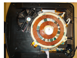
Intérieur de la plaque à induction (19 000 Hz, 160 V)
