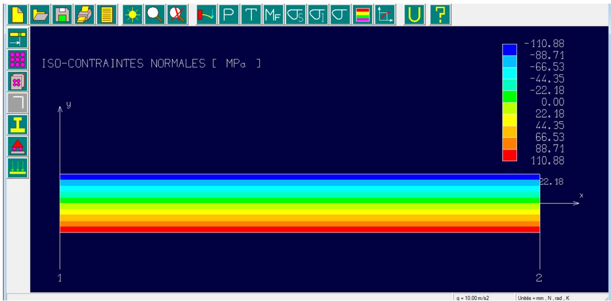
Figure 16 : Vérification poutrelle IPE – étape 8
