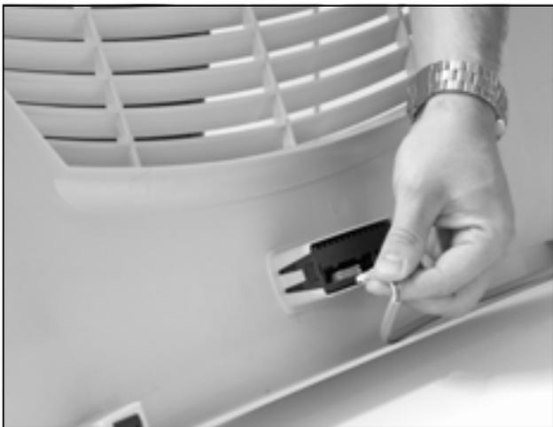
Fig. 24 : Ôter le connecteur de l'afficheur
