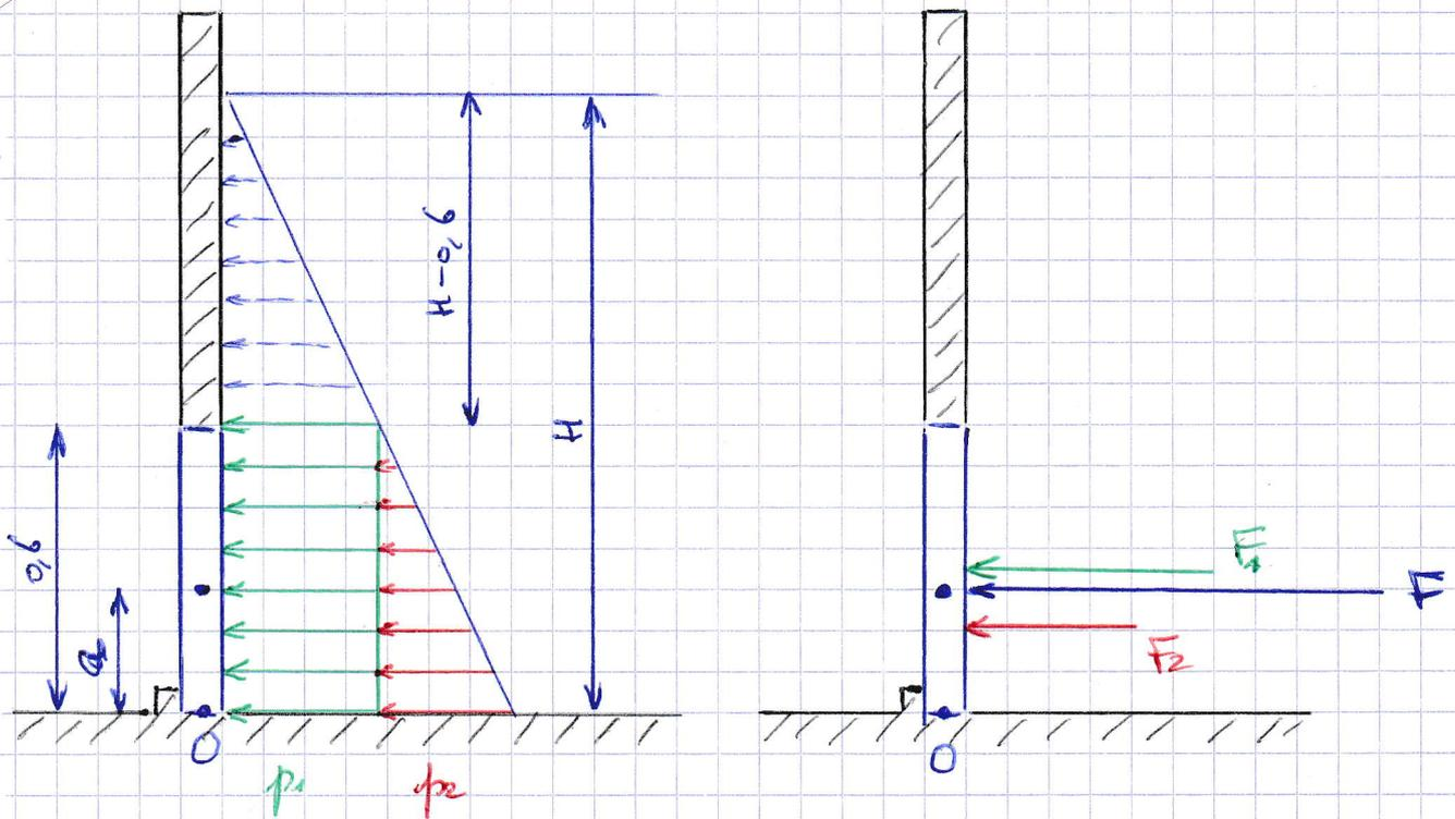
$F$ : résultante des forces de pression sur la plaque. Celle-ci bascule si  $F$  est au dessus de l'axe. A la limite, le moment de  $\vec{F}$  par rapport au point  $O$  (= l'axe) vaut  $\vec{M} = a \cdot F$  (en module)
