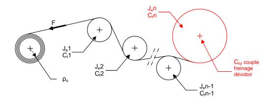
L'effort de traction est maximal au départ car l'inertie  $J_e$ n de la bobine dévidée est maximale. Si la partie rouge est motorisée et munie d'un dispositif assurant la tension du film juste après le dévidoir, on ne compte ni l'inertie ni le couple de freinage de cette partie. Les caractéristiques de déroulement du dévidoir peuvent être calculées au chapitre suivant.
