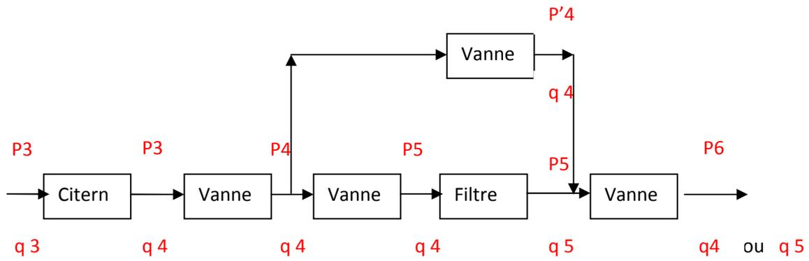
Si le liquide traverse la vanne sans passer par le filtre le débit obtenu est  $q_4$  par contre si le liquide passe directe vers le filtre le débit obtenu est  $q_5$  mais en plupart des cas le liquide passe par le filtre, donc pour la suit on utilise le débit  $q_5$ .
