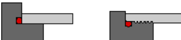
Figure 35: Section d'un joint O-ring de tube
