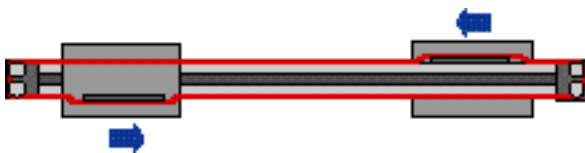
Figure 83: Principe de déplacements opposés synchronisés
