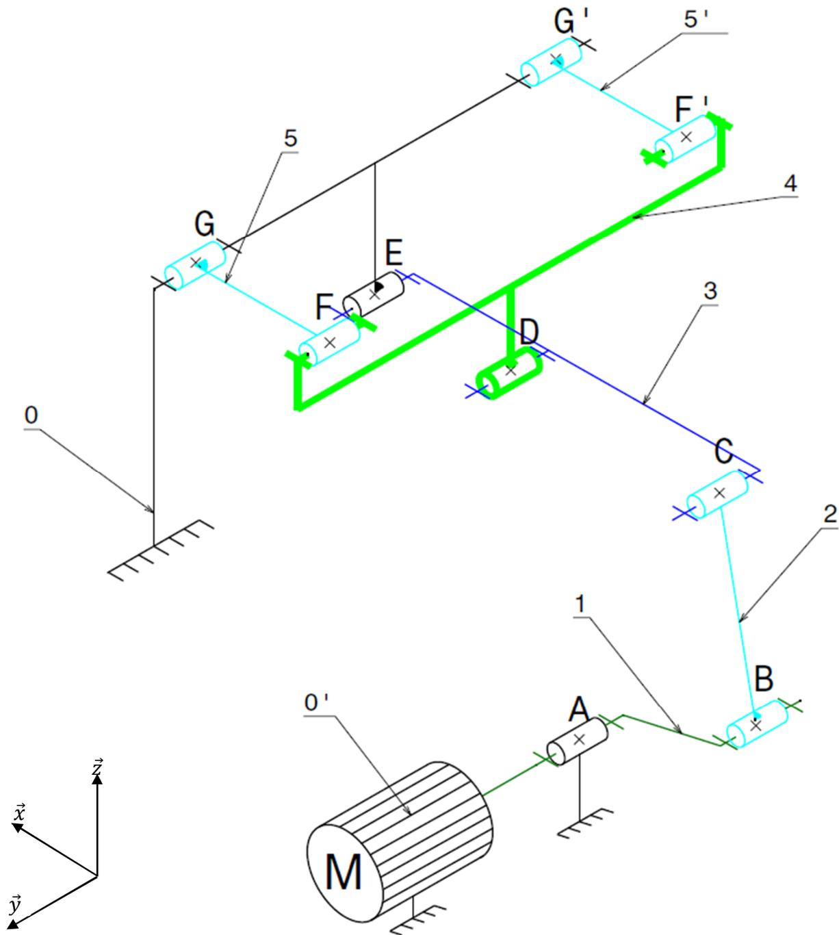
Figure 3.8 : Schéma cinématique minimale (3D) (Solution 1).
