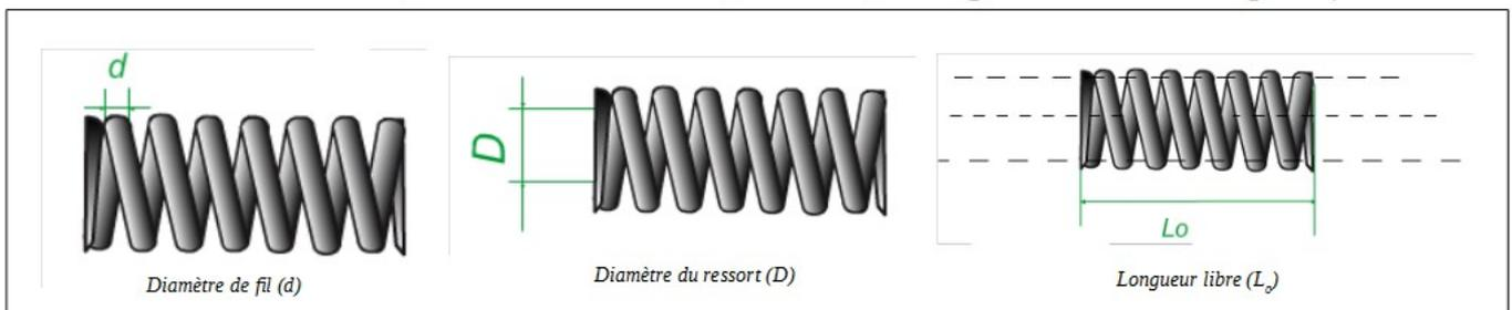
La raideur  $k$  d'un ressort à compression est sa résistance à la déformation élastique. Elle s'exprime en N/mm. Pour la calculer, on utilise la formule  $k = \frac{F}{f}$ .  $F$  correspond, ici, à la force exercée sur le ressort et s'exprime en newtons N.
