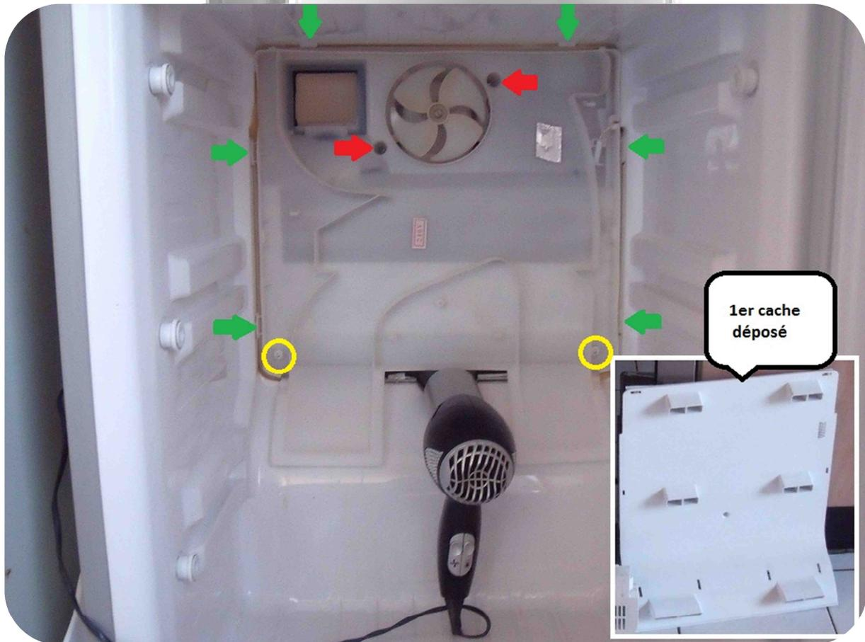
Ne pas se soucier des deux vis entourées en jaune qui sont montées du côté opposé et qui n'empêchent pas la dépose du cache.
