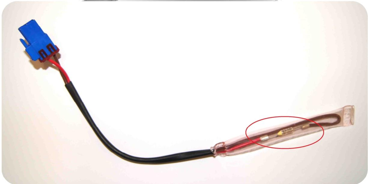
Au vu du faible coût de la sonde de dégivrage et du thermofusible, j'ai préféré remplacer les deux même si le thermofusible ne me semblait pas défilant.
