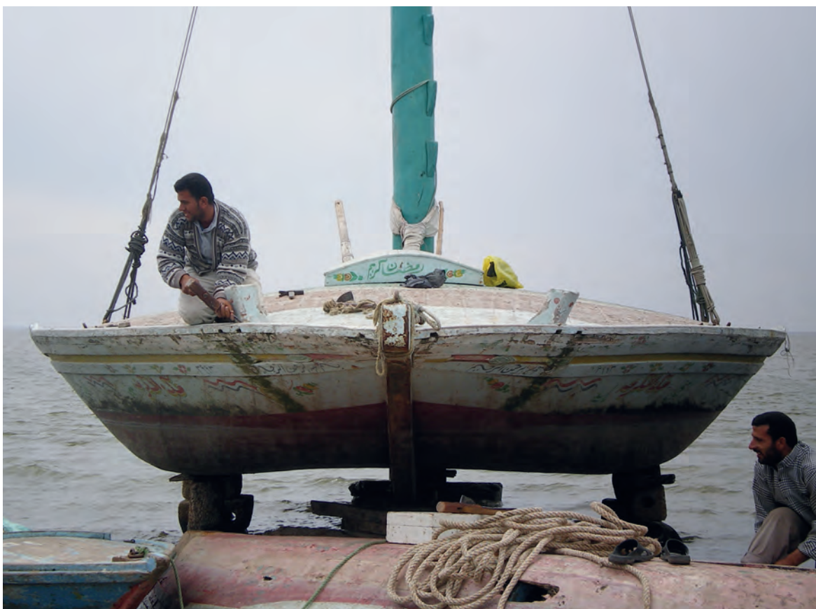
Figure 9 : Lokkafa sur cales. Noter le profil transversal du fond de carène à double courbure en « aile de mouette ». Cliché P. Pomey, © CEALex/CNRS
