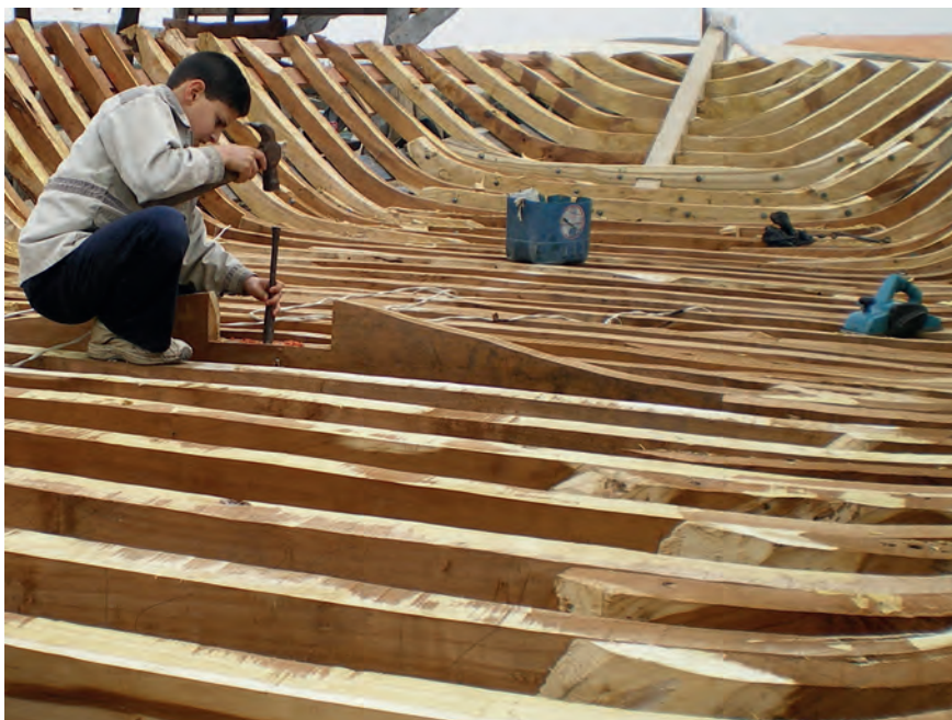
Figure 12 : Charpente transversale (membrure) d'un grand lokkafa en cours de construction à Borg el-Borollos. Noter la varangue centrale, en cours de brochage, taillée pour recevoir le massif d'implanture du mât. Cliché P. Pomey, © CEALex/CNRS
