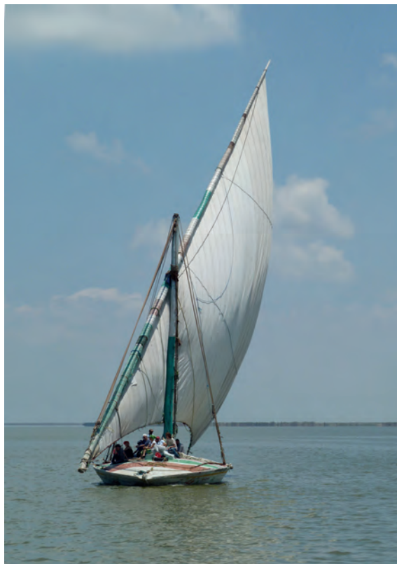
Figure 7 : Grand lokkafa sous voile, vue de face. Noter la tonture inversée du pont. Cliché P. Pomey, © CEAlex/CNRS
