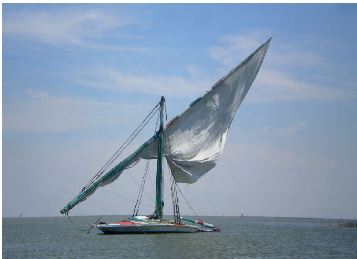
Figure 10 : Grand lokkafa au mouillage, voile serrée, sur le lac Borllos. Noter le gréement et le grand gouvernail. Cliché P. Pomey, © CEAlex/CNRS
