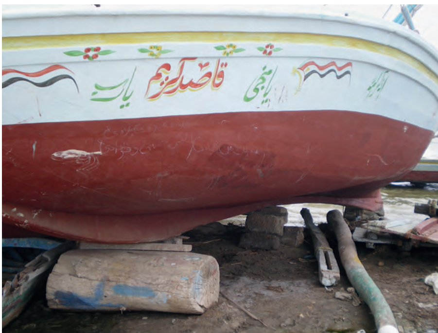
Figure 8 : Lokkafa tiré au sec à Borg el-Borollos. Noter la quille fortement arquée et le décor de la coque. Cliché P. Pomey, © CEALex/CNRS
