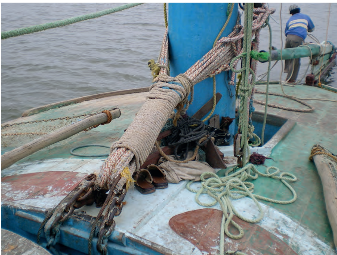
Figure 11 : Détail de la forte ligature maintenant la base du mât du lokkafa . Cliché P. Pomey, © CEALex/CNRS
