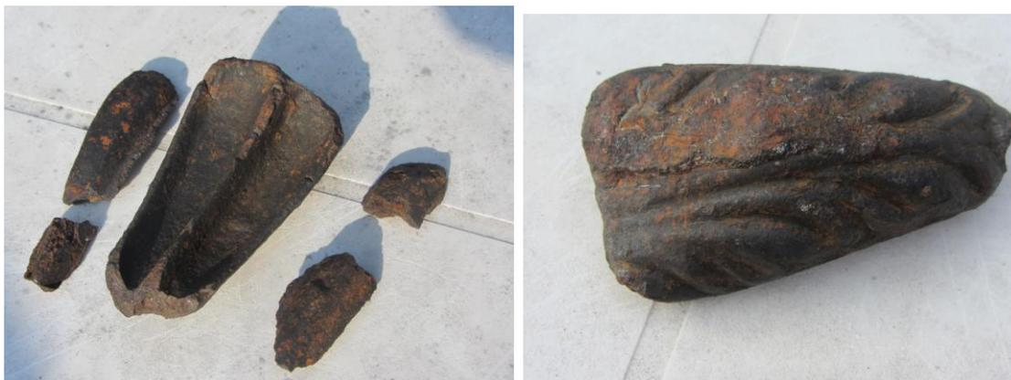
Sur la photo de gauche, les éléments qui se sont détachés des rainures et vue sur la casse que j'ai opérée au marteau précédemment pour voir l'aspect du matériau; sur la photo de droite, au milieu et en haut, une mince couche qui est restée adhérente.
