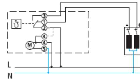
Régulation par pompe de circulation ou chauffage par accumulation / à air chaud
