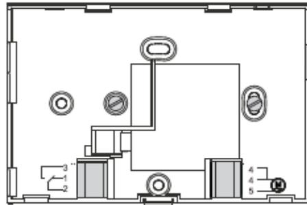
Bornes de connexion appareil      Bornes de connexion réseau 230 V seulement RAMSES® 812 top
