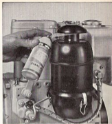
Planche 12: Démarrage par basses températures (Startipilot)
