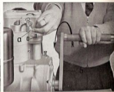
Planche 8: Démarrage sans décompression automatique, coté distribution
