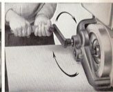
Planche 10: Bonne position pour démarrage coté volant
