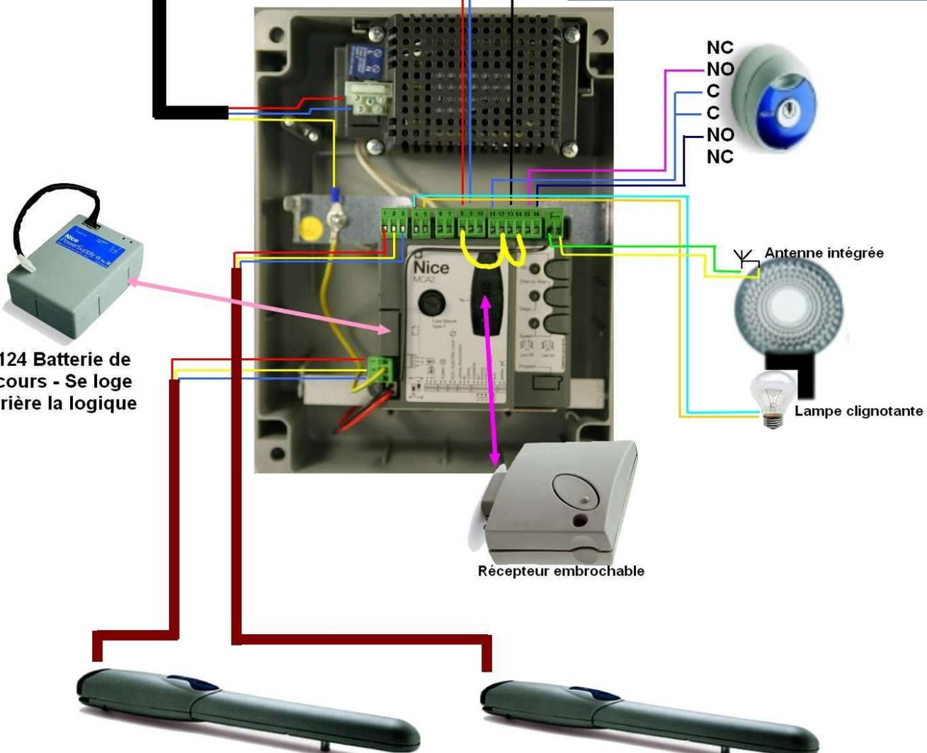
Une fois les connexions raccordées, mettez sous tension les leds L1 à L5, P1-P2-P3
