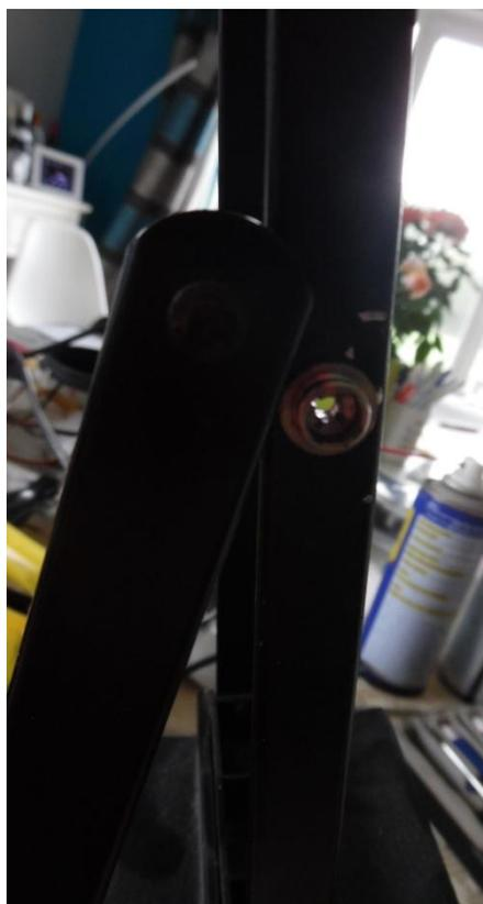
Une vis parker fixe une pièce en plastique rouge dans laquelle vient un axe métallique déterminant l'écartement.
