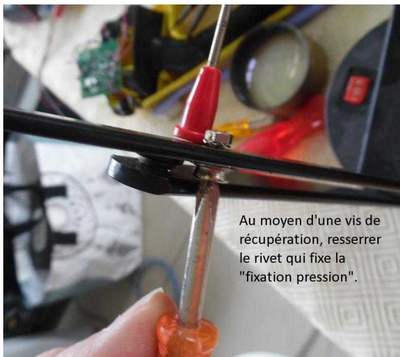
Au moyen d'une vis de récupération, resserrer le rivet qui fixe la "fixation pression".
