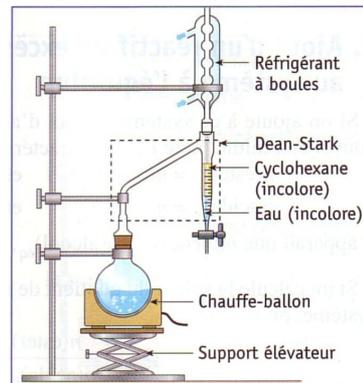
✓ Au mélange réactionnel de l'expérience A du document 1, on ajoute un solvant organique ((cyclohexane) moins dense que l'eau et on adapte ce montage.
