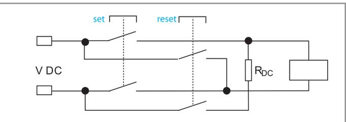
En appuyant sur le poussoir SET, le relais est magnétisé au travers de la diode, les contacts passent en position travail, et y restent.
