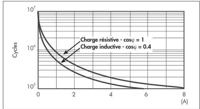
F 40 - Durée de vie électrique (AC) en fonction de la charge
