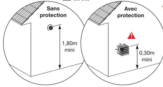
⚠ Les évacuations débouchant directement sur une voie de circulation extérieure doivent comporter un déflecteur inamovible donnant aux gaz évacués une direction sensiblement parallèle au mur.
