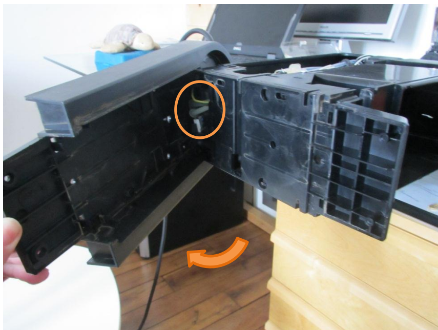
Socle désolidarisé avec sens d'extraction et matérialisation des tuyaux et fils (Remarque : les carénages gauche et droit ont déjà été déposés sur cette photo)
