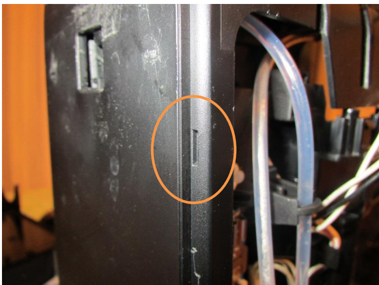
Logement d'un ergot dans la partie arrière de la machine
