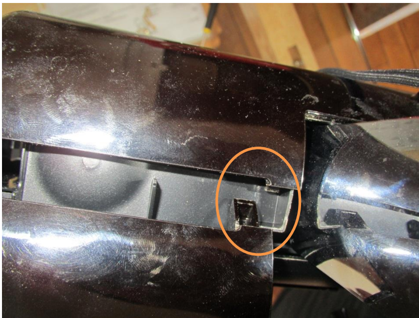
Attaches de fixation entre les deux carénages sur leur partie supérieure
