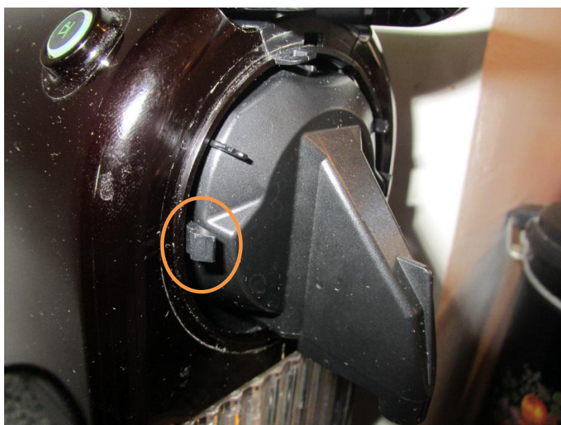
Ergot de fixation de l'enjoliveur du bec
