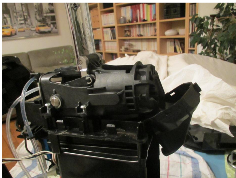
Bec de la machine déclipé de l'unité de brassage
