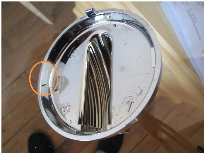
Patte d'ancrage des ergots sur l'enjoliveur
