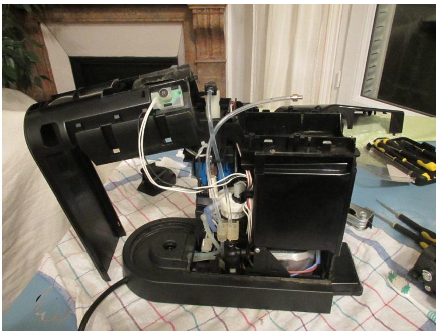
Vue de la machine avec unité de brassage déposée
