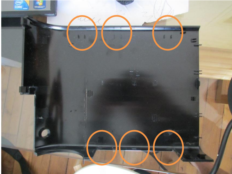
Position des ergots sur le carénage latéral gauche (le carénage de droite est identique)
