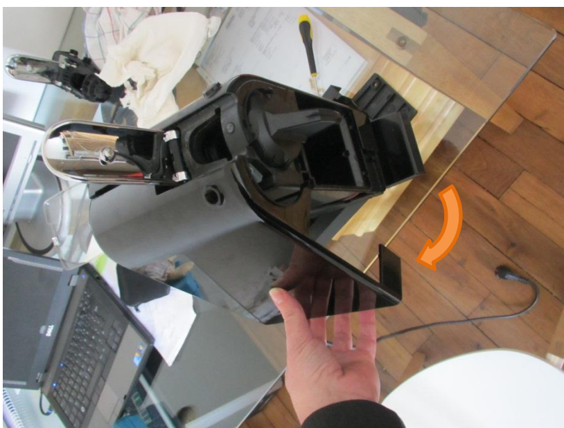
Retrait du carénage gauche en faisant levier vers le haut
