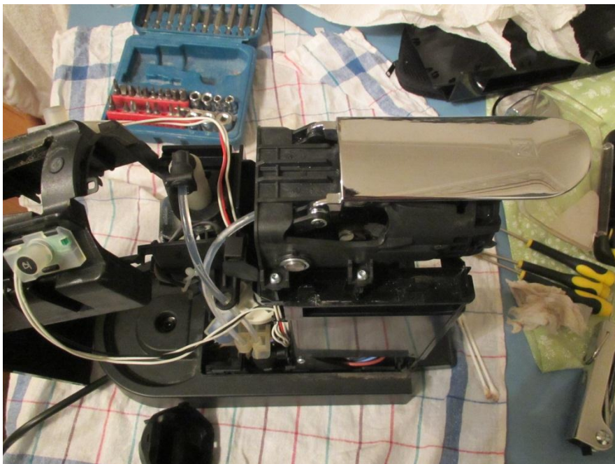
Capot intérieur mis de côté et vue sur l'unité de brassage
