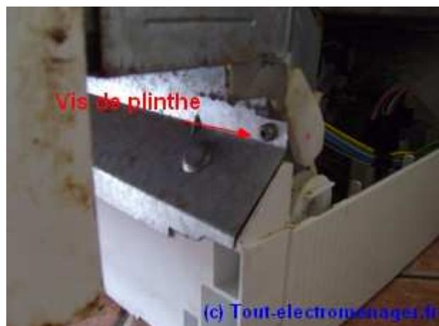
**Le socle:** C'est la partie la plus contraignante. Le socle maintient les organes sous la machine. Après avoir retiré les vis qui le maintiennent au montant de cuve, il faut le retourner. Déboîter alors les pattes de tension de câbles de porte. Il est ensuite possible que la filerie soit gênante, ou encore que le tuyau d'arrivée d'eau bloquant pour l'ouverture.
