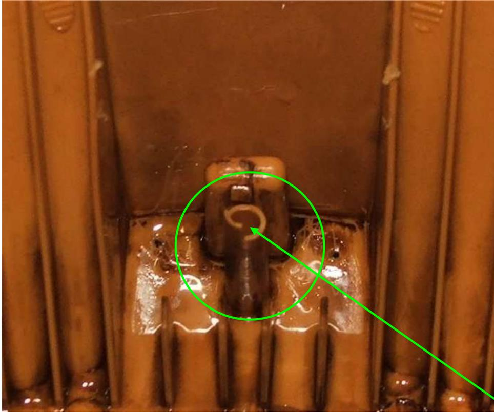
Il suffit alors avec un tournevis suffisamment petit pour passer dans le creux du support et d'aller nettoyer la boue qui c'est accumulée au fils du temps tout au fond.
