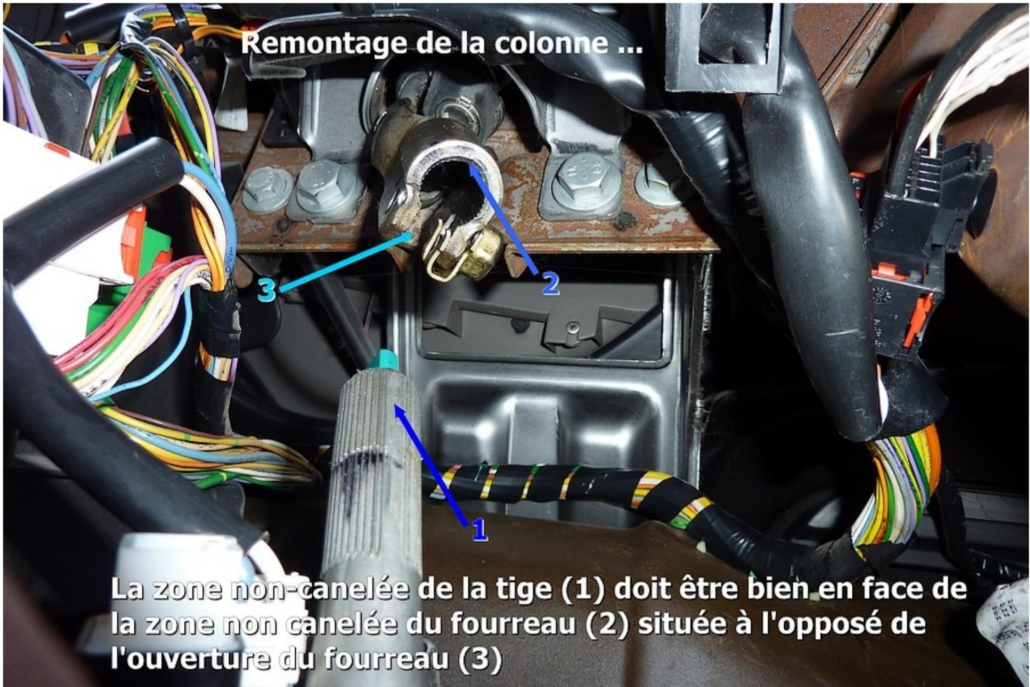
**La zone non-canelée de la tige (1) doit être bien en face de la zone non canelée du fourreau (2) située à l'opposé de l'ouverture du fourreau (3)**
