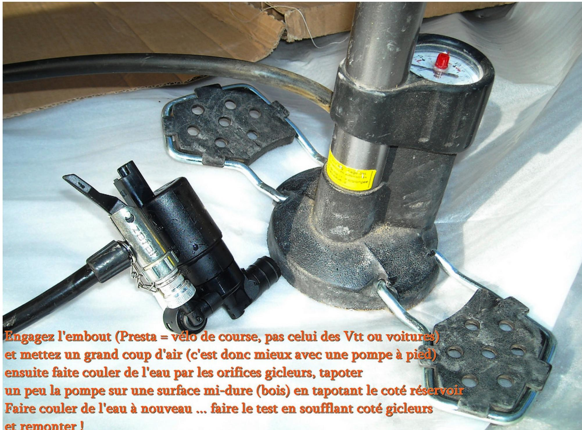
Engagez l'embout (Presta = vélo de course, pas celui des Vtt ou voitures) et mettez un grand coup d'air (c'est donc mieux avec une pompe à pied) ensuite faites couler de l'eau par les orifices gicleurs, tapoter un peu la pompe sur une surface mi-dure (bois) en tapotant le coté réservoir Faire couler de l'eau à nouveau ... faire le test en soufflant coté gicleurs et remonter !
