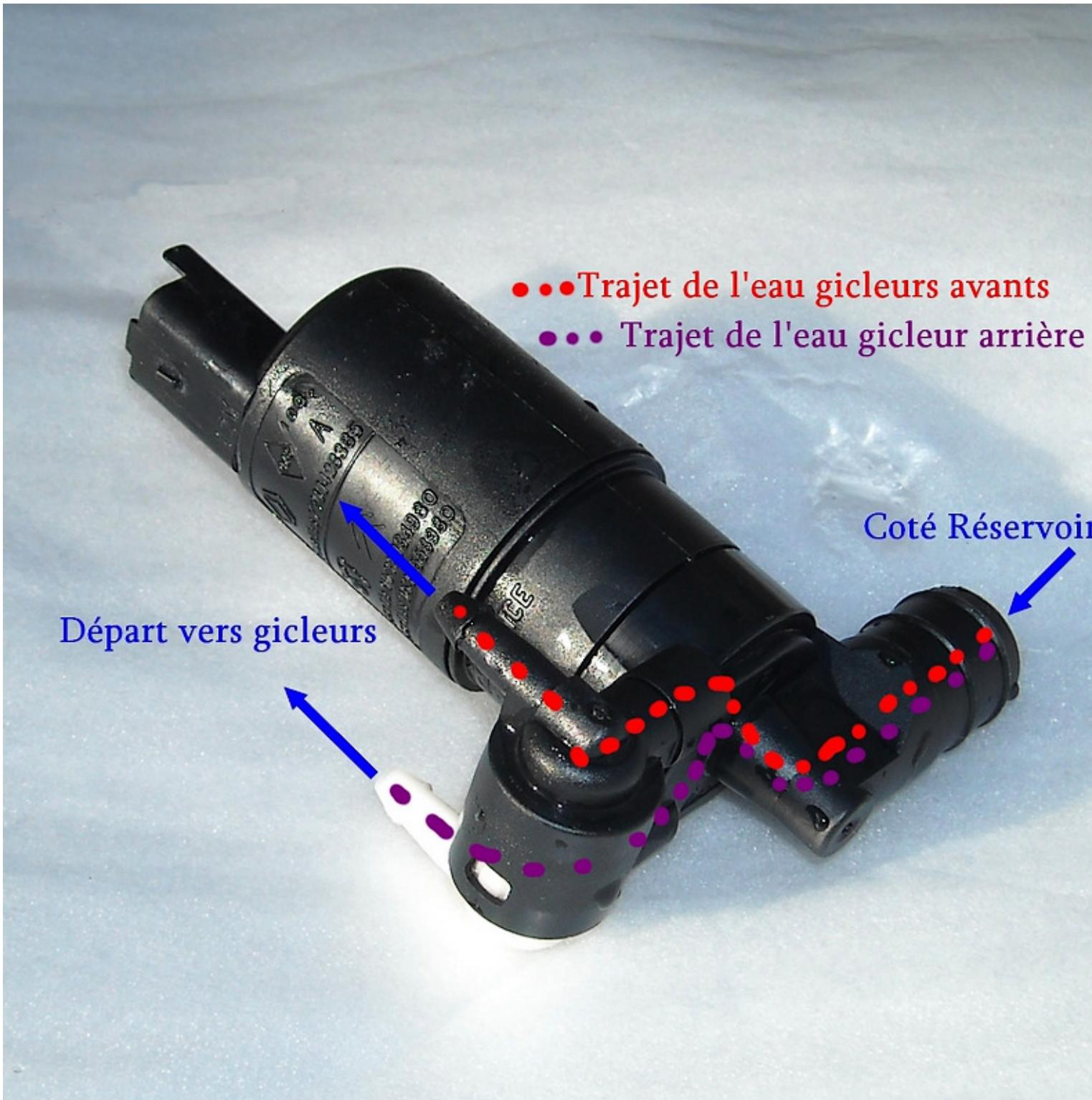
1/ Si pas d'eau à l'avant souffler en 1, l'air doit avoir du mal ou ne pas sortir coté réservoir 1
