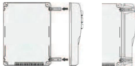
Après les réglages et les configurations, fixez le couvercle avec les vis fournies.
