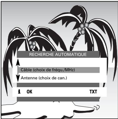
A l'aide de la touche  $\text{P-}$  ou  $\text{P+}$ , sélectionnez «Câble choix de fréqu./MHz» ou «Antenne choix de canal». Lancez la «RECHERCHE AUTOMATIQUE» (recherche ATS) à l'aide de **OK**.
