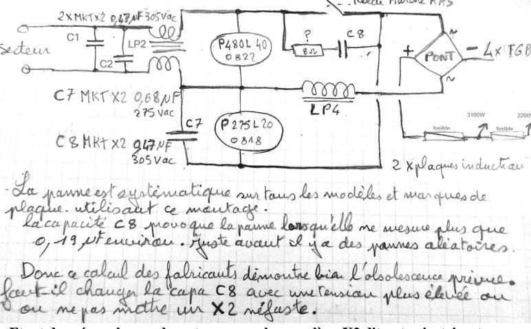
Etant donné que les condensateurs au polypropylène X2 dit auto cicatrisants perdent de la capacité à chaque amorçage d'un arc électrique traversant l'isolant C8 passe avec le temps de 680nf à 196nf en provoquant des pannes aléatoires avant d'arriver à ce stade fatal que les fabricants ne veulent pas reconnaître
