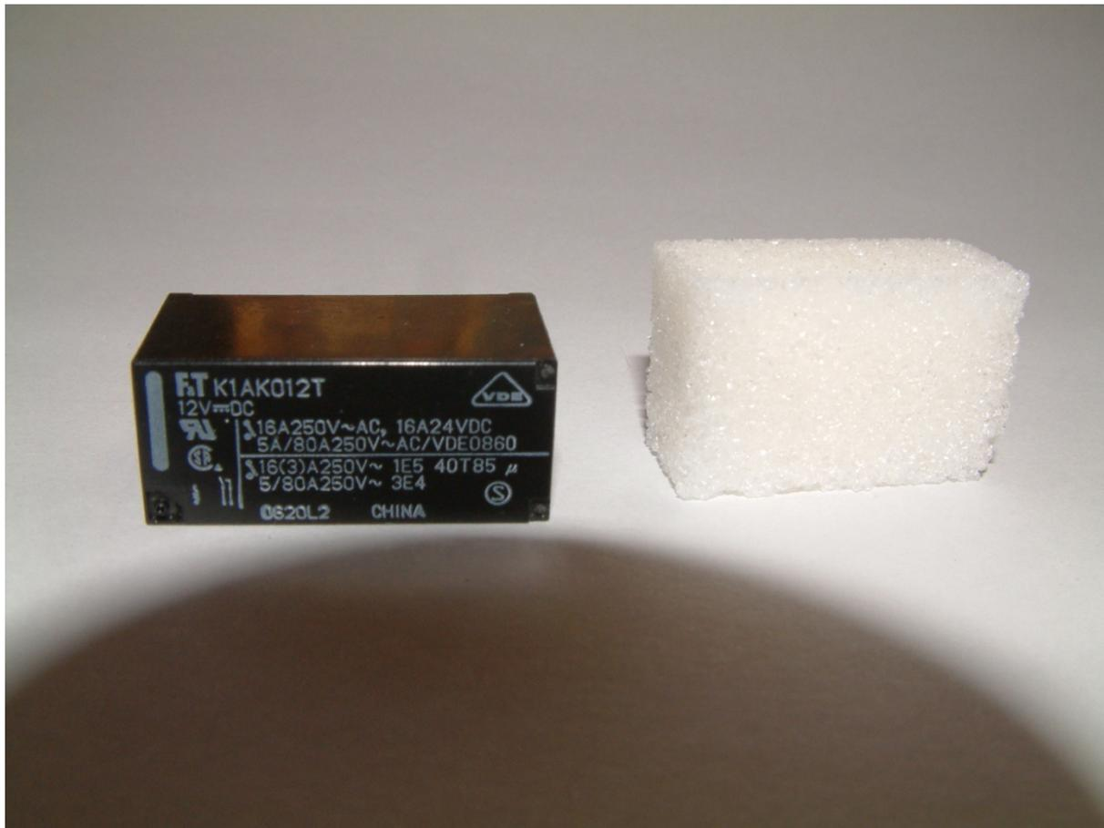
Et ,ci-dessous ,pour les électriciens ( les vrais ) ce que j'appelle « les pattes de mouches » de ce relais a qui on fait supporter, « allégrement » 18,5 Ampères et parfois comme j'ai pu le constater grâce aux «Led » en face avant
