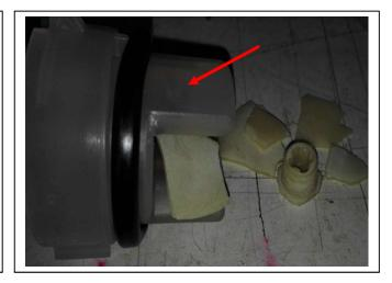
Assurez-vous qu'aucune partie du disque ne soit bloqué dans le cache protecteur du détecteur présence eau. Nettoyez le cache si nécessaire.
