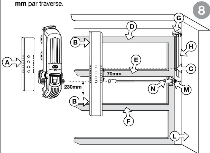
2) Au moyen des deux vis et relatifs écrous indesserrables enlevés précédemment, remonter le motoréducteur sur la base "A" (ou sur la plaque surdimensionnée en option "B" **GLOPS2**), avec éclairage de zone dirigé vers le haut et axe du moteur dans la position préétablie.
