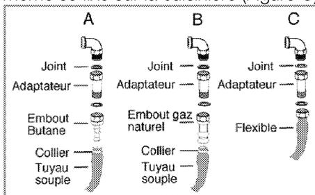
L'embout butane permet le raccordement par tube souple en caoutchouc de diamètre intérieur de 6 mm destiné aux gaz distribués par bouteilles.
