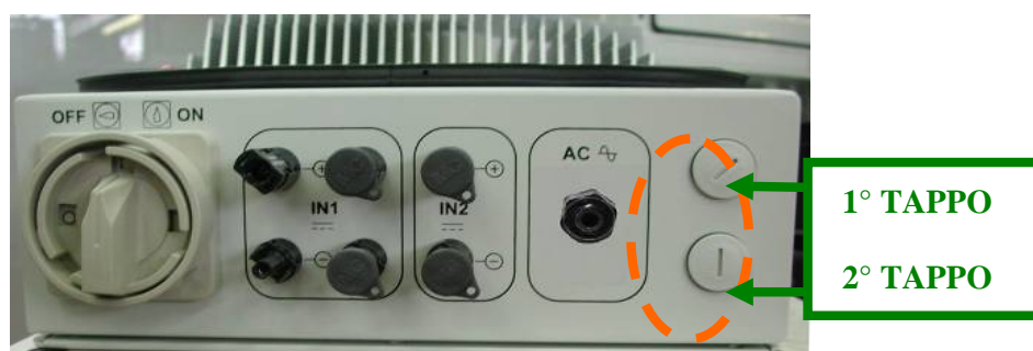
Fig. 23 - Trous par lesquels passent les câbles pour la connexion RS-485 ou les câblages pour la connexion des connecteurs RJ12
