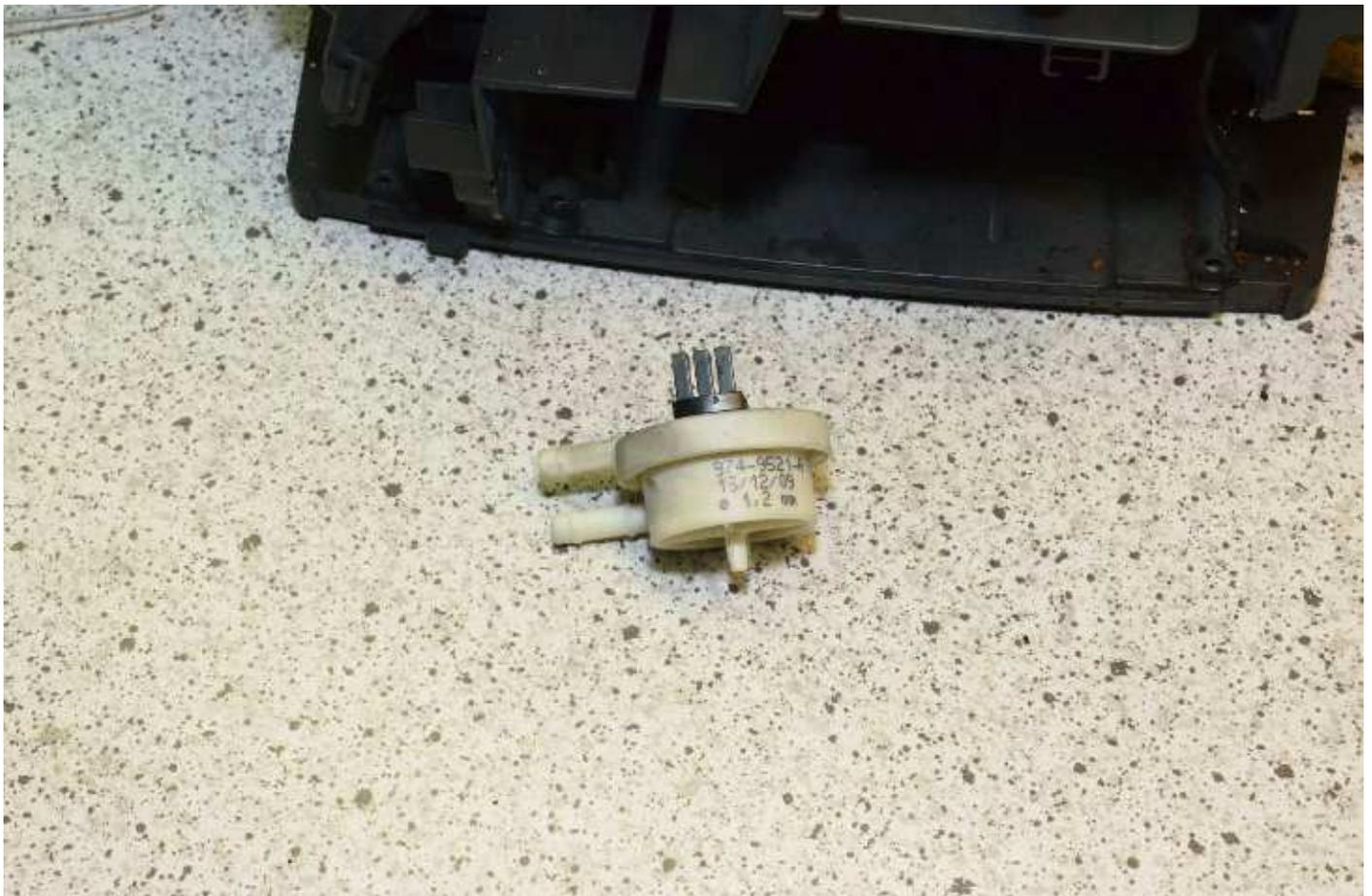
Heizung ausbauen. Die 2 Wasserschläuche abziehen.
