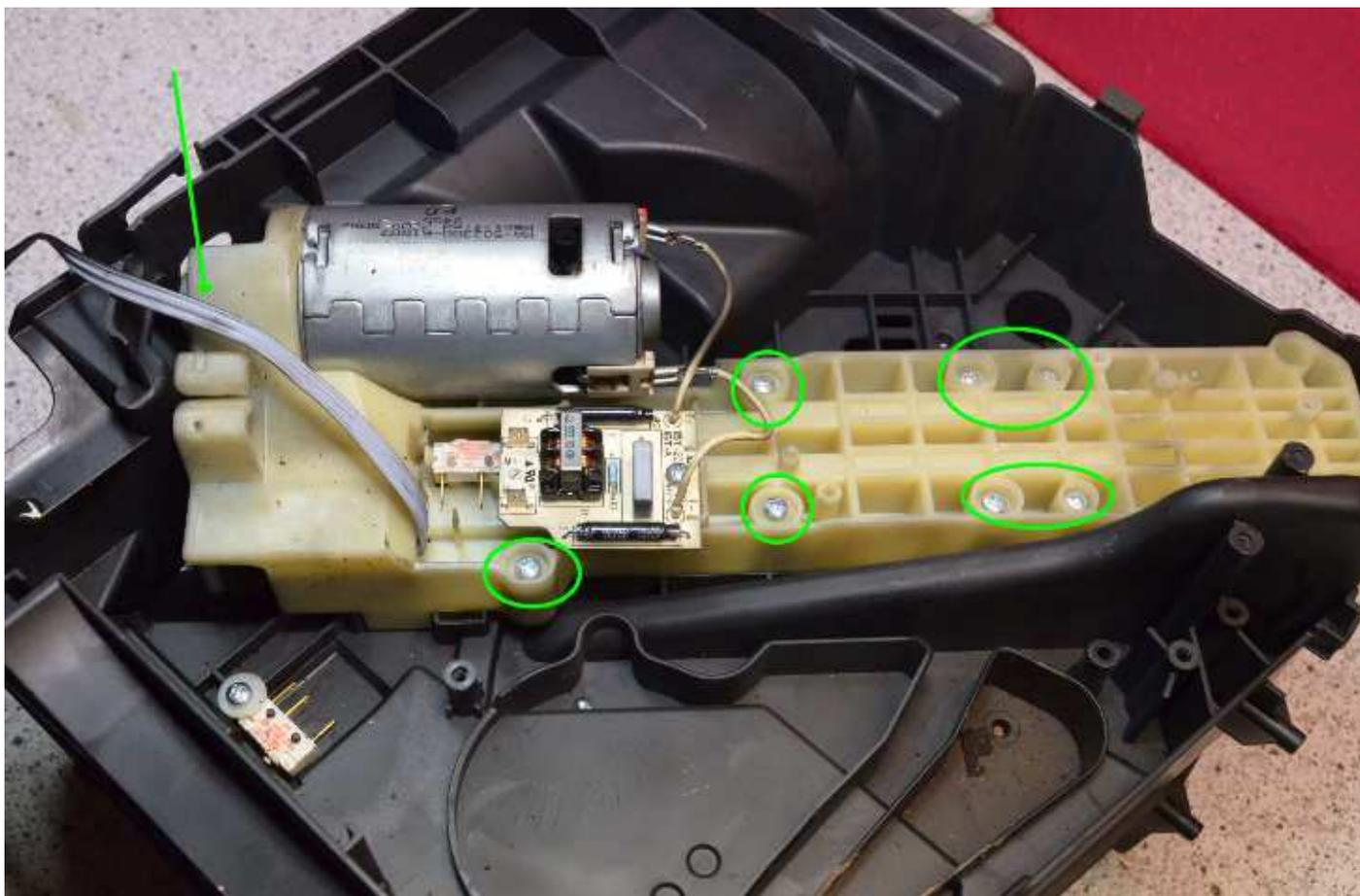
2 Torx und die Schraube unter der BG Aufnahme ausdrehen.
