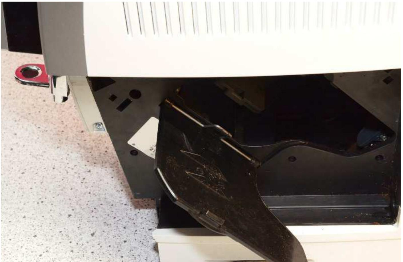
Jetzt den Bügel nach oben schieben und den Deckel entnehmen.
