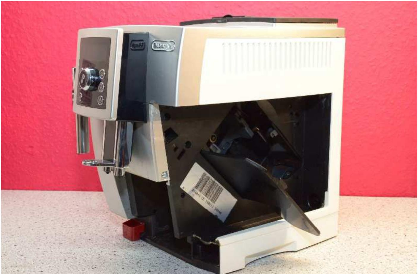
Um den Brühgruppendeckel zu entnehmen, wird der Bügel ausgeklipst.
