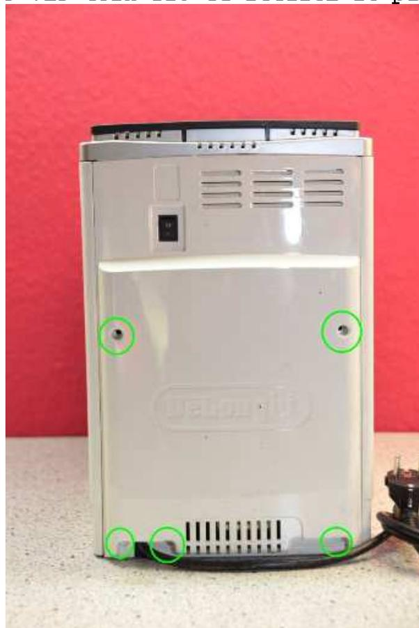
Rechts und links die Seitenwände entfernen.
