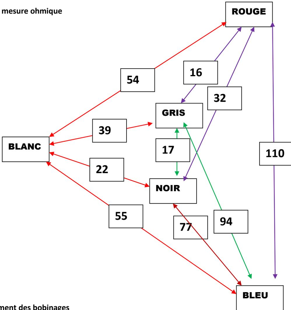
Raccordement des bobinages
