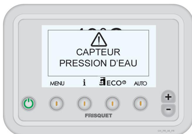
*Le capteur de pression d'eau ne communique plus avec la carte de régulation*
