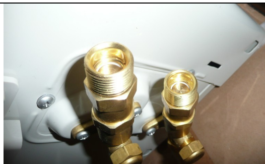
Les 2 raccords entrée compresseur ils ont la même taille
