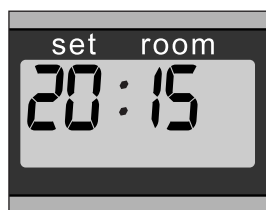
E: Nel momento in cui i quattro numeri smettono di lampeggiare, la stufa è stata programmata secondo i dati impostati.
