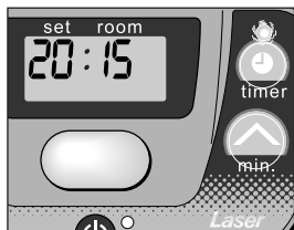
G: Kontrollampen TIMER angiver, at TIMER funktionen er aktiveret.
