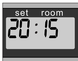
E: Når informationsdisplayet stopper med at blinke, er indstillingen låst til den indstillede værdi.
