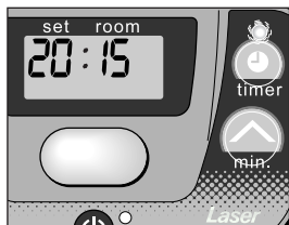
G: La spia luminosa di controllo TIMER indica che la funzione del timer è attiva.
